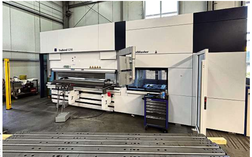
Die neue Tru Bend 5230 mit automatischem Werkzeugwechsler Tool Master ist nicht nur eine Investition für die Zukunft, sondern auch in die Gesundheit der Mitarbeiter.
