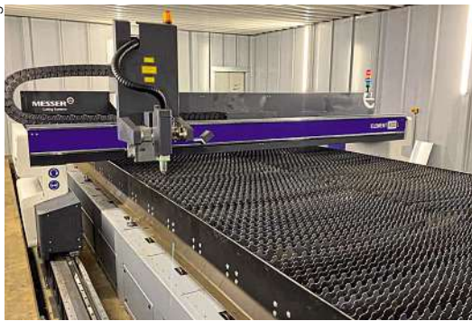
Die Laserschneidmaschine Element L 400 mit einem 8-kW-IPG-Faserlaser, einem Fasenschneidkopf für Fasen bis zu \pm 50^\circ und einem maximalen Bearbeitungsbereich von 3.000 mm x 8.000 mm ersetzt bei Beuting nun eine 15 Jahre alte Plasmaschneidanlage Omnimat L 7000.
