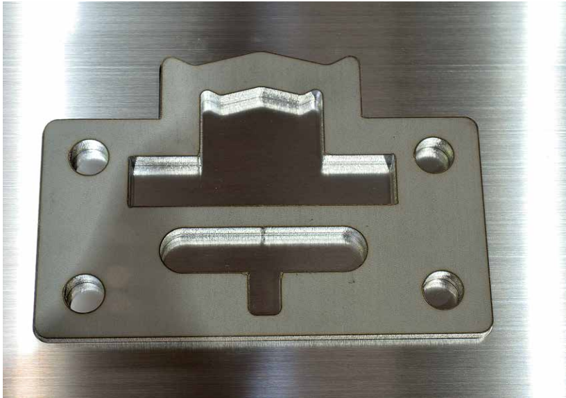
Mit der Ventis-Technik geschnittenes Musterteil aus 4 mm dickem Edelstahl.
