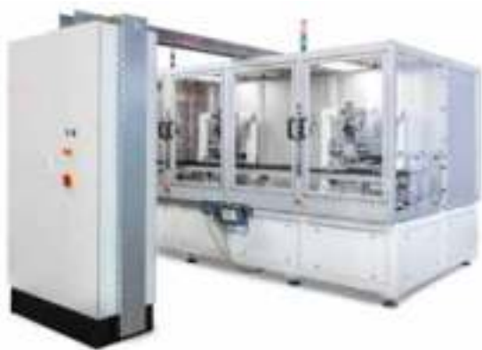
Für sichere und optimale Schweißergebnisse sollte die Anlage genau auf den Produkttyp oder das Material angepasst sein – in diesem Fall für das Rotorschweißen. (Foto: LMB Automation GmbH)
