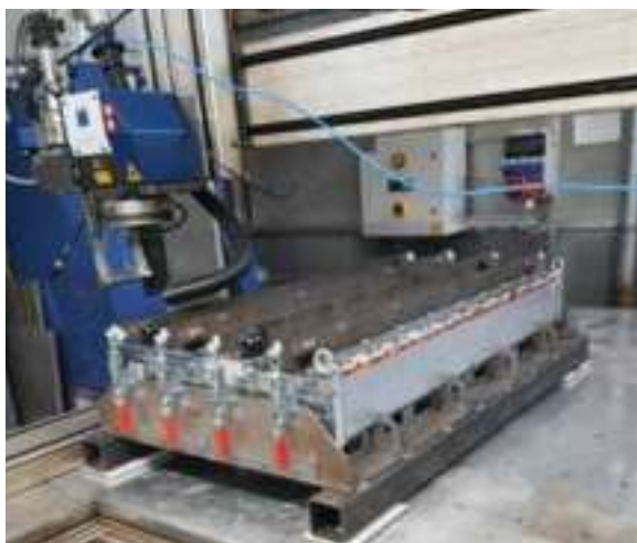
E-Batterien für Flurförderfahrzeuge oder LKWs machen aufgrund ihrer besonderen Geometrien, dem Einsatz reflektierender Materialien und ihrer Dimension eine Anpassung der Laserschweißanlage erforderlich. (Foto: LMB Automation GmbH)
