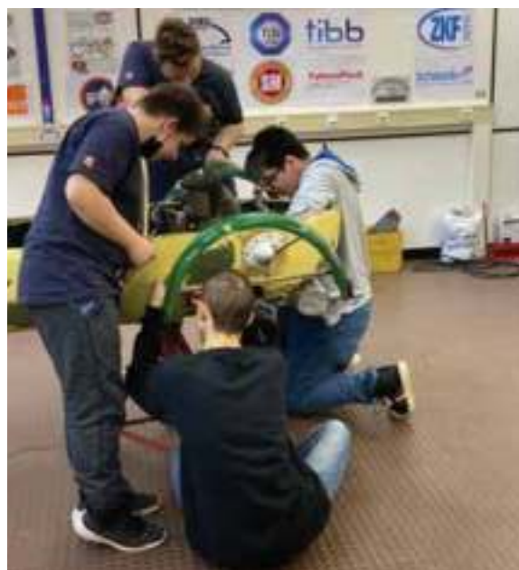
Einbau der restaurierten Hinterachse. (Foto: yourmove e. V.)
