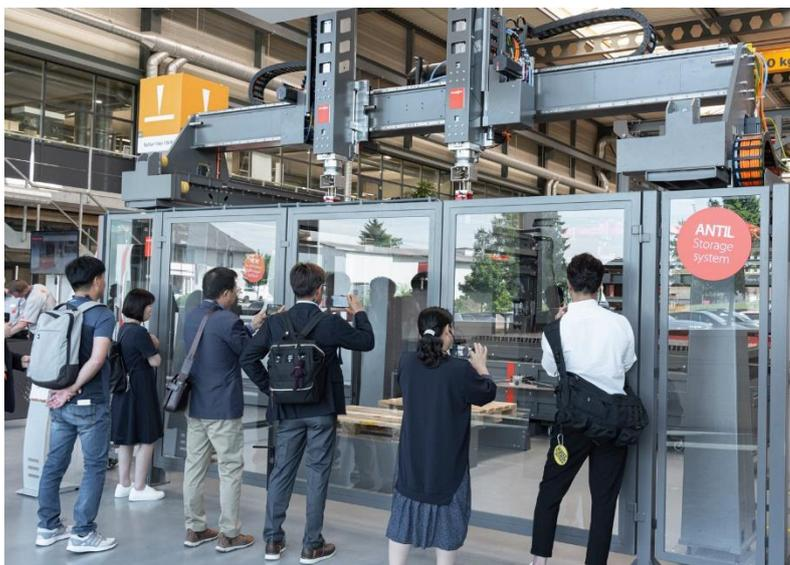
Vollautomatisierter Materialfluss: Mit ByTrans Cross und BySort präsentierte Bystronic eine flexible Lösung für das Handling von Rohmaterial und Schneidteilen.
