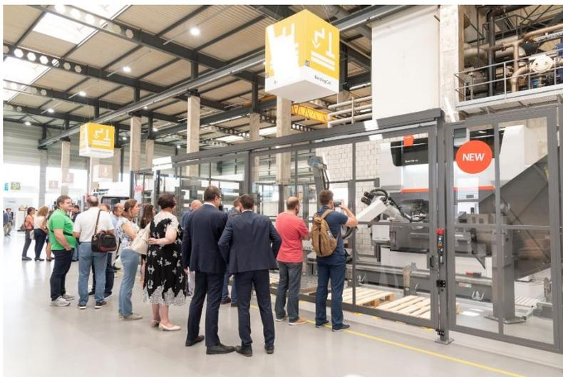
Vollautomatisiertes Biegen: Die Abkantpresse Xpert Pro mit Robotik. Die Automation übernimmt das Einrüsten, das Biegen, den Greiferwechsel und legt die fertigen Biegeteile sortiert ab.
