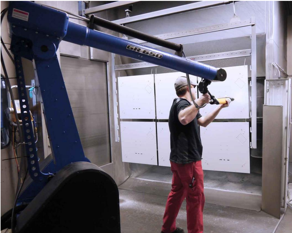
Self-teaching Programmierung des Lackierers am Musterstück.
