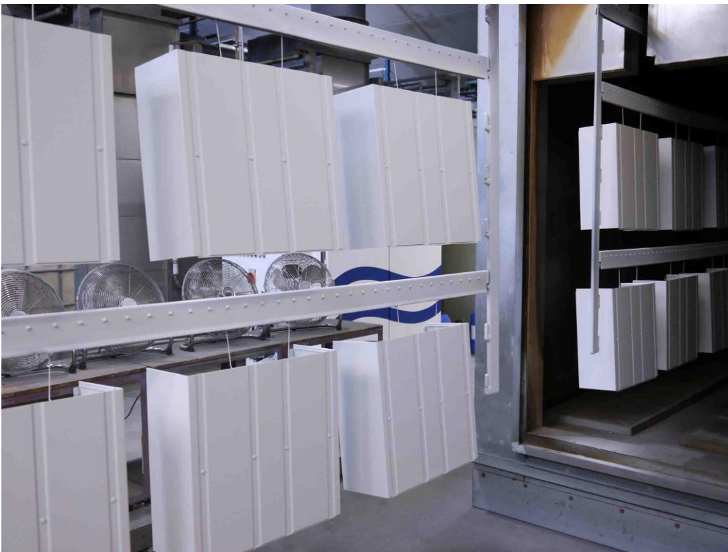
Pulverlackierte Gehäuseteile direkt aus dem Brennofen der Pulverbeschichtungsanlage
