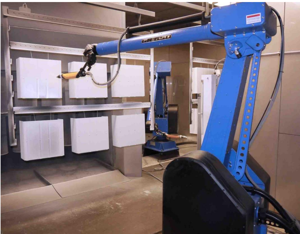
Automatischer Lackiervorgang der Pulverroboter
